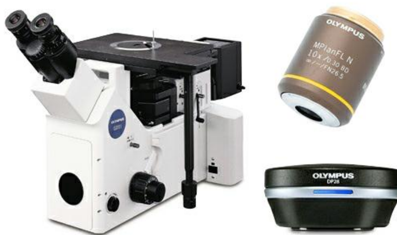
Configuration type de l'équipement : microscope métallurgique inversé, objectif métallographique 10X, caméra numérique pour microscope haute résolution
